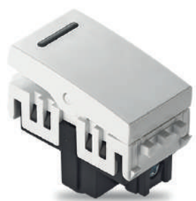
Módulo interruptor simple 10A/250VAC, contactos de Cu/Zn con aleación de Ag, cumple IEC60669
