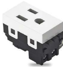
Módulo tomacorriente tipo USA 16/250VAC, contactos de Cu/Zn con aleación de Ag, cumple IEC60884
