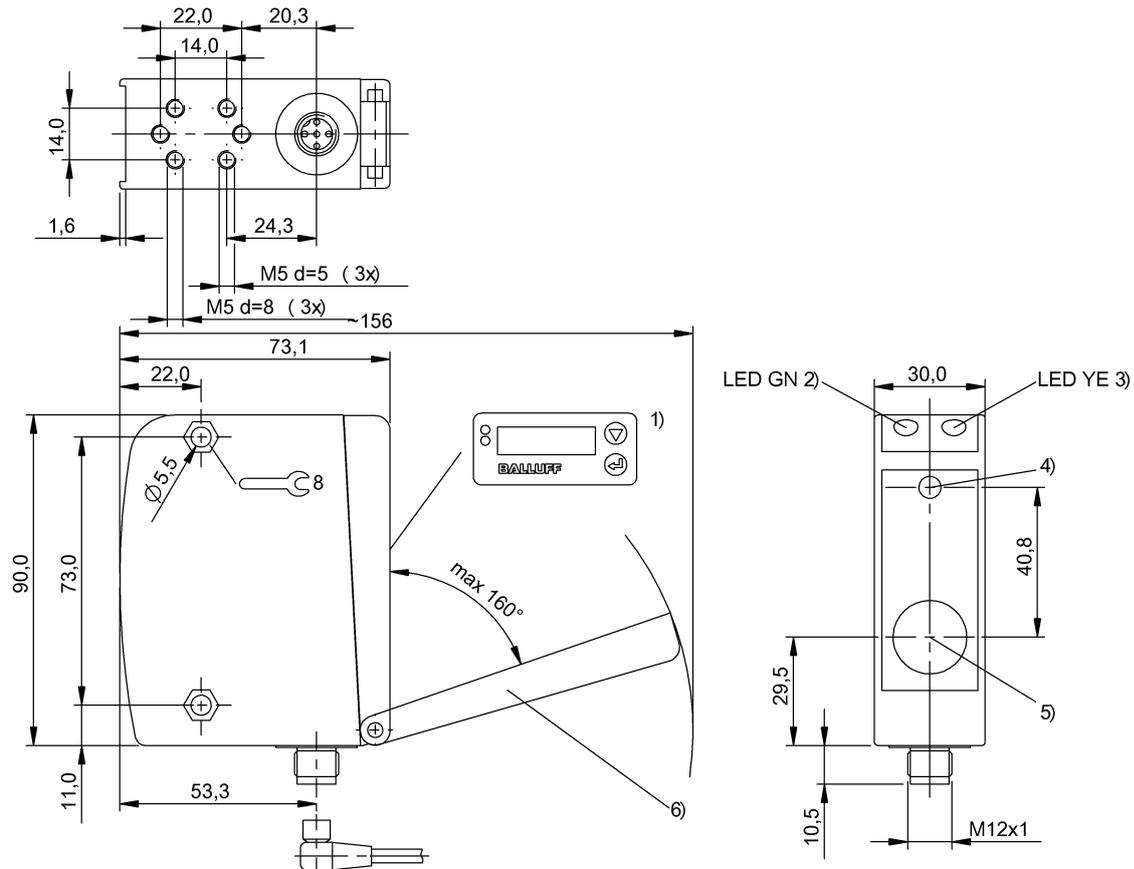
1) Pantalla y teclado, 2) Tensión de servicio, 3) Función de salida, 4) Eje óptico de emisor, 5) Eje óptico de receptor, 6) Tapa desmontable
