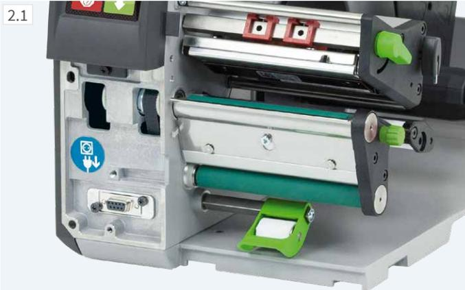
**Todos los cabezales de impresión de la misma anchura se pueden intercambiar a voluntad. La CPU los detecta y calibra automáticamente.** Los datos importantes, como el rendimiento, la temperatura de servicio máxima y la energía para calentamiento se guardan directamente en el cabezal de impresión. Los valores pueden leerse en fábrica.
