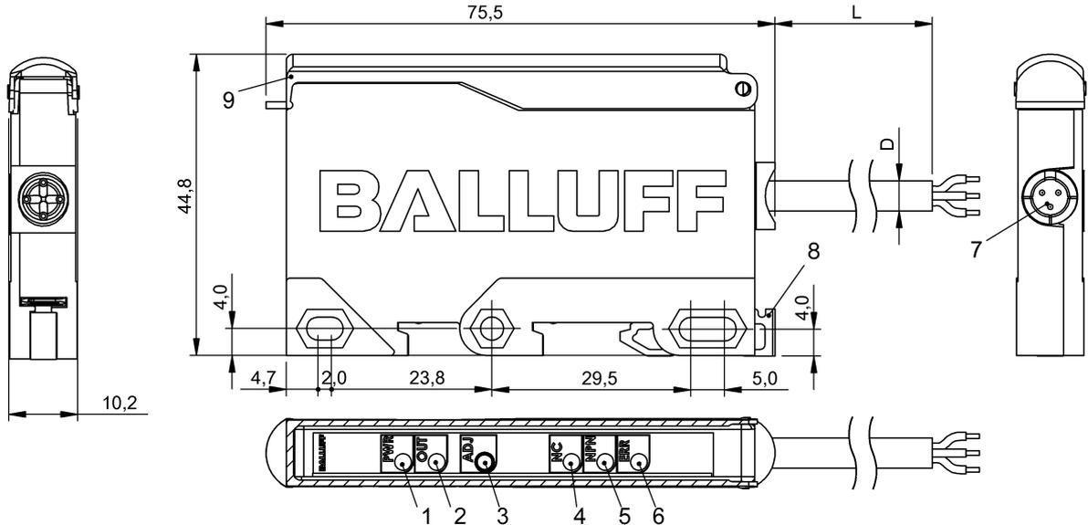
1) LED tensión de servicio, 2) LED de indicación de función, 3) Sn, 4) LED función contacto NA activo, 5) LED etapa de conmutación NPN activa, 6) LED Error, 7) Conexión de sensor, 8) Montaje sobre rail 35 mm, 9) Tapa
