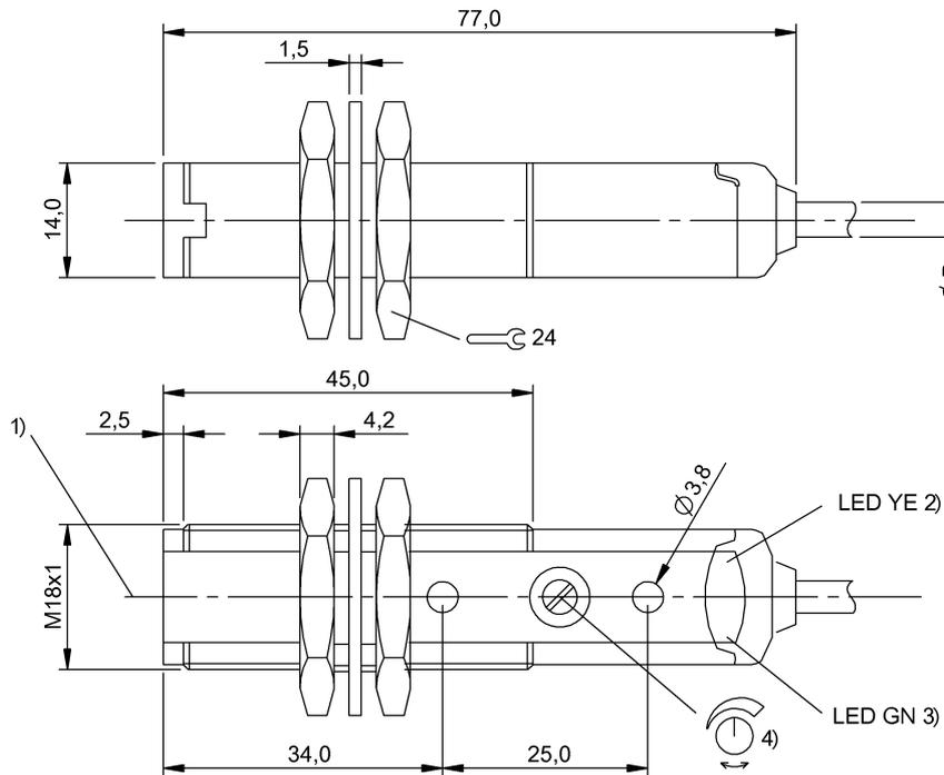
1) Eje óptico, 2) Función de salida, 3) Estabilidad, 4) Sn
