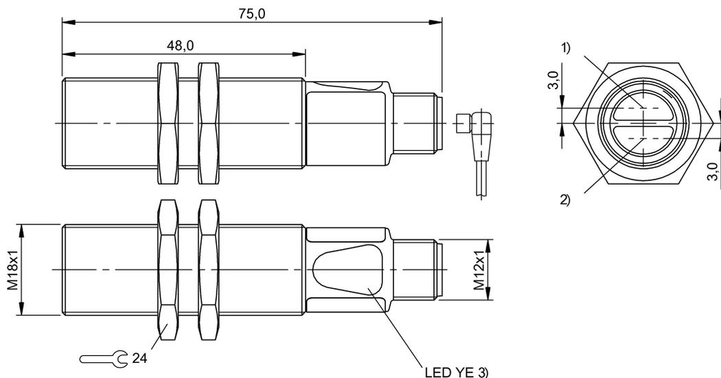
1) Eje óptico de receptor, 2) Eje óptico de emisor, 3) Recepción de luz/rango límite
