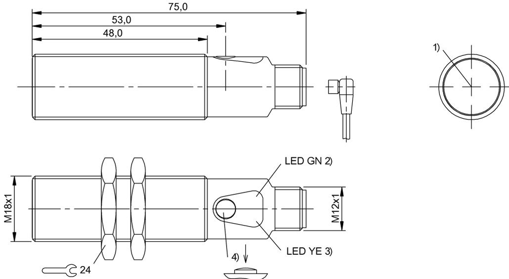
1) Eje óptico, 2) Tensión serv./cortocircuito, 3) Recepción de luz/rango límite, 4) Sn
