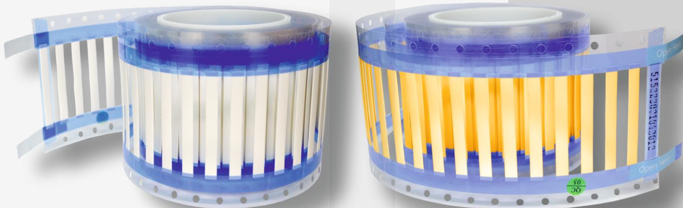
Estos tubos de identificación termorretráctiles están diseñados para satisfacer las necesidades de marcado de cables y alambres de los fabricantes con requisitos de alto rendimiento. Hecho de poliolefina termorretráctil reticulada por radiación permanente, retardante de llama.
