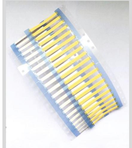
Estos marcadores termocontraíbles permiten identificar y codificar sobre todo tipo de cables de control y fuerza. Al termocontraerse, los manguitos se fijan fuertemente sobre el cable y la tinta de impresión queda capturada en el material asegurando una marca durable y permanente.
