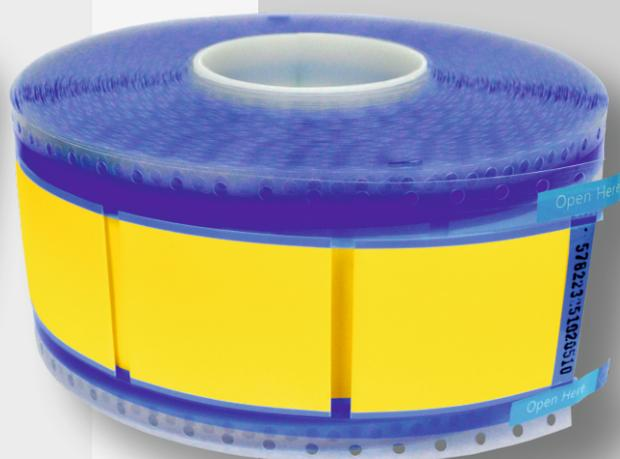
Estos tubos de identificación termorretráctiles están diseñados para satisfacer las necesidades de marcado de cables y alambres de los fabricantes con requisitos de alto rendimiento. Hecho de poliolefina termorretráctil reticulada por radiación permanente, retardante de llama.
